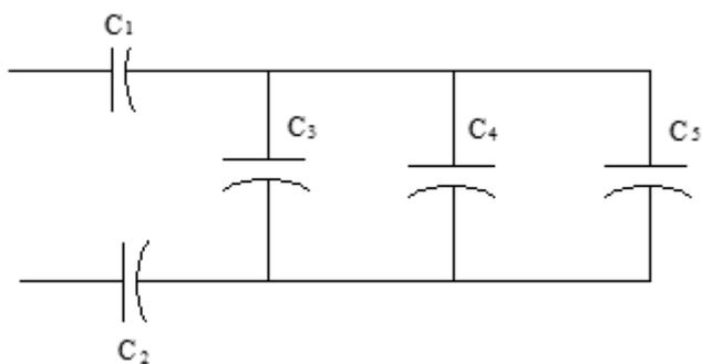
Dados:  $C_1=20\mu\text{F}$ ,  $C_2=60\mu\text{F}$ ,  $C_3=30\mu\text{F}$ ,  $C_4=20\mu\text{F}$  e  $C_5=10\mu\text{F}$ .
