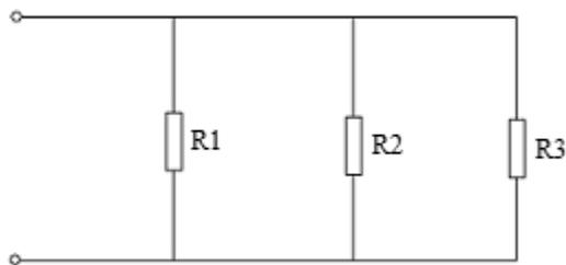
Dados  $R_1=10\Omega$ ,  $R_2=15\Omega$  e  $R_3=6\Omega$ .
