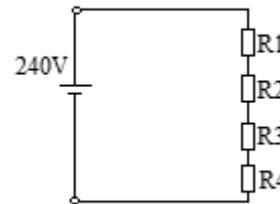
Dados:  $R_1=50\Omega$ ,  $R_2=40\Omega$ ,  $R_3=20\Omega$  e  $R_4=10\Omega$ .
